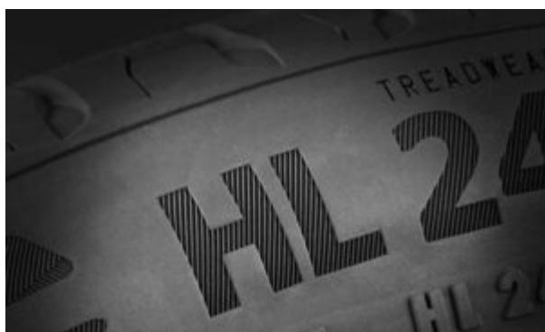
Ces pneus sont identifiés par les lettres « HL » apposées devant la dimension. Ce marquage atteste d'une capacité de charge additionnelle d'environ 10% par rapport à la version Extra load.
