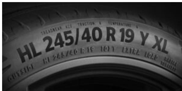
À la différence de l'augmentation de pression nominale entre un pneu standard et un pneu Extra load, les versions HL possèdent la même pression nominale que les pneus Extra load.
