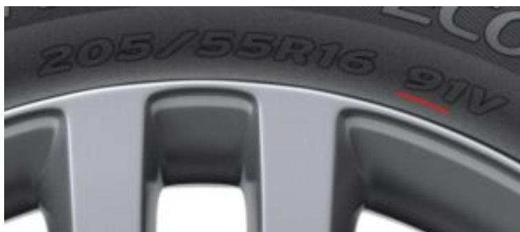
Dans notre exemple, pour la dimension 205/55R16 l'indice de charge 91 indique la capacité du pneumatique à supporter un poids de 615 kg.
