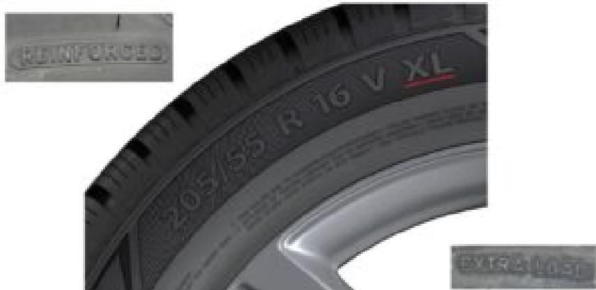
Ces marquages attestent de la capacité de charge supplémentaire du pneumatique pour une dimension donnée. Cette capacité additionnelle des pneus Extra load nécessite une pression plus élevée que pour la version standard.
