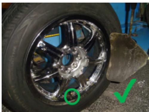
**Attention** : la bêche de détalonnage doit être impérativement placée juste au-dessus du rebord de jante. Si celle-ci est placée trop haut sur le flanc, il peut y avoir rupture de la carcasse ce qui provoquera des déformations type hernie lors de regonflage du pneumatique.
