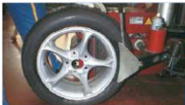
**1.** Dégonfler le pneumatique en retirant le bouchon et l'intérieur de valve.
