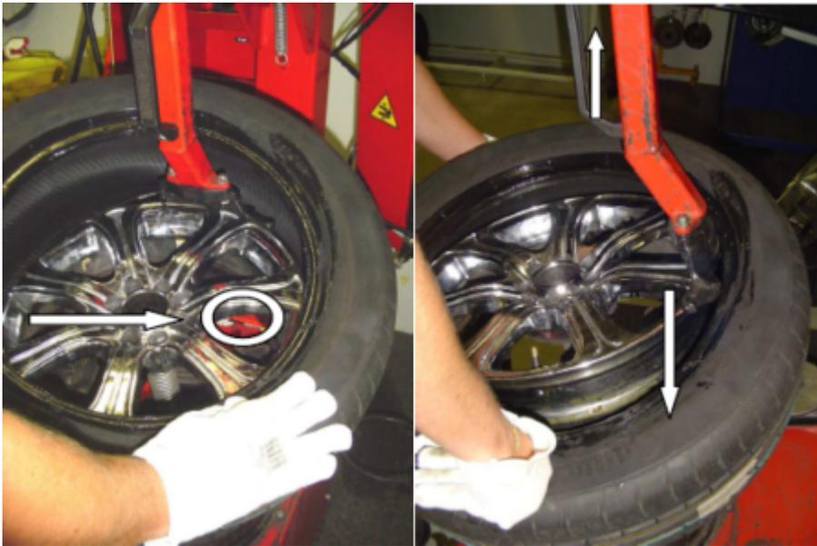
Pour les tailles basses (faible hauteur de flanc), il est recommandé d'utiliser un coin-talon (collier - voir photo ci-dessous) ou s'aider du bras pousse-talon (troisième main) dont certaines machines sont équipées.
