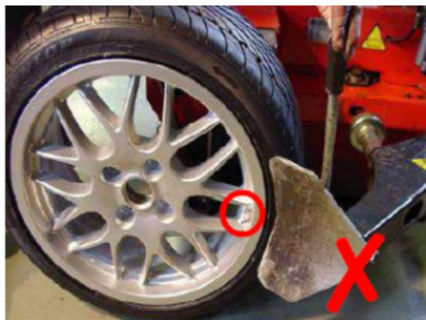
Lors de la manoeuvre de détalonnage, il est indispensable de placer l'outil de détalonnage à au moins une vingtaine de centimètres de la valve afin de ne pas risquer d'endommager le capteur de pression sur valve (de plus en plus présent sur les nouveaux véhicules).
