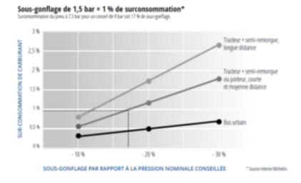
La pression de gonflage exerce une réelle influence sur la consommation de carburant. Une pression de gonflage inadaptée augmente la résistance au roulement des pneumatiques et donc la consommation de carburant du poids lourd. Un sous-gonflage de 1,5 bar (7,5 bars au lieu de 9 bars) entraine 1% de sur consommation (pour 17% de sous-gonflage).
