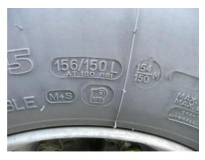
Le point singulier correspond généralement, par rapport au point nominal, à une diminution de capacité de charge associée à une augmentation de vitesse, ou l'inverse.
