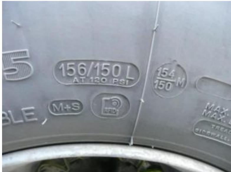
Le point singulier correspond généralement, par rapport au point nominal, à une diminution de capacité de charge associée à une augmentation de vitesse, ou l'inverse.
