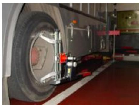
Le déréglage du parallélisme peut être soit entre roues, soit en essieux. Le parallélisme peut se dérégler par suite de chocs, usure, desserrage de pièces mécaniques, jeux anormaux, etc...
