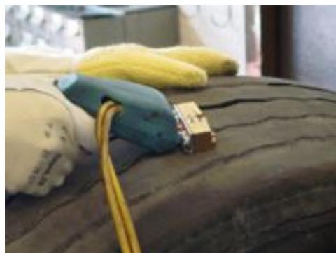
Autorisé par le code de la route et recommandé par les Manufacturiers de Pneumatiques, le recreusage permet de redonner du potentiel d'adhérence au pneu, d'accroître de façon notable le rendement kilométrique et de réaliser une économie de carburant car le pneu poursuit sa vie dans la période où sa résistance au roulement est la plus faible.
