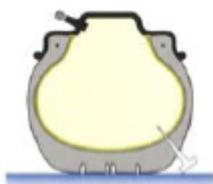
C'est un pneu avec chambre à air déjà incorporée, qui est donc étanche seul. Un pneu TUBELESS doit être toujours monté sur une roue TUBELESS.
