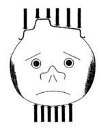
Le surgonflage doit être évité, sauf pour le labour en coteaux et quand le tracteur doit travailler longtemps sur sol dur.
