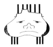
Le sous-gonflage peut endommager la carcasse du pneu. Une déflexion exagérée et permanente du pneu, hors des limites conseillées par le manufacturier et précisées dans sa documentation technique, peut engendrer la rupture de la carcasse.
