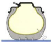
C'est un pneu avec chambre à air déjà incorporée, qui est donc étanche seul. Un pneu TUBELESS doit être toujours monté sur une roue TUBELESS.
