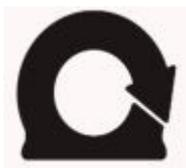
Marquage applicable aux pneumatiques radiaux homologués en tant que pneumatique à mobilité étendue (EMT = Extended Mobility Tyre). Ces pneumatiques ont subi un test de roulement à plat spécifique.
