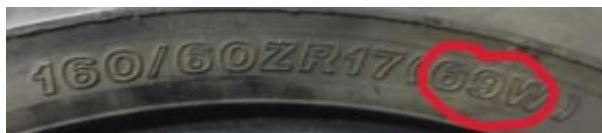
Dans le cas où le pneumatique est capable de vitesses supérieures à 270km/h, les conditions d'utilisation doivent être marquées entre parenthèses (comme sur l'exemple ci-dessus).
