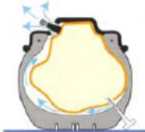
C'est un pneu qui n'est pas étanche seul, il nécessite l'usage d'une chambre à air.
