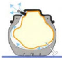
C'est un pneu qui n'est pas étanche seul, il nécessite l'usage d'une chambre à air.
